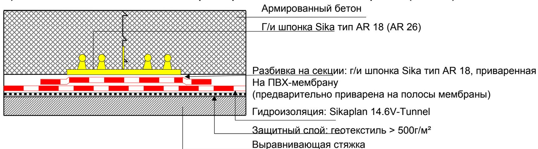
В.) Г/и шпонка Sika тип AR, приваренная к ПВХ-мембране (фундаментная плита)
